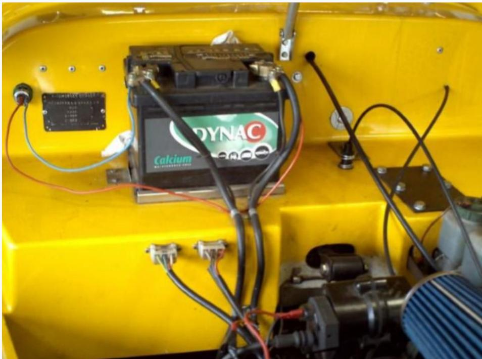
Les 2 connecteurs blancs sont destinés à l'ensemble du système électrique du moteur et de l'éclairage. Juste à côté de la batterie, la plaque constructeur « Le Patron » et à côté de cette plaque, vous avez des fils d'alimentation ( par exemple système de navigation).
