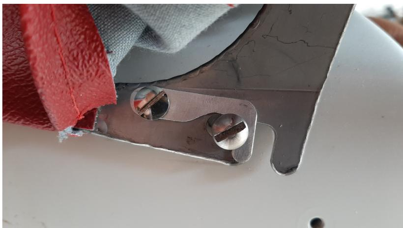
Après quelques tests de mise en place et modification du profil du crochet pour qu'il prenne bien sa place, marquer la position du trou dans l'armature et percer (3,3mm idéalement) pour ensuite tarauder un filet M4.
