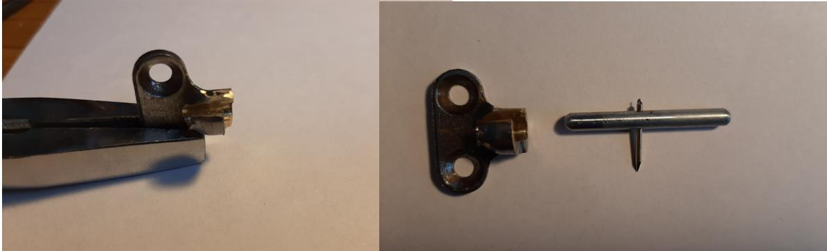
Couper environ 36mm dans la barre de diamètre 4mm qui va devenir l'axe du verrou. Vérifier si ce morceau coulisse dans le corps de la charnière, s'il ne coulisse pas facilement, ce n'est pas grave, on peut réduire son diamètre avec du papier abrasif en le faisant tourner sur une perceuse colonne par exemple.
