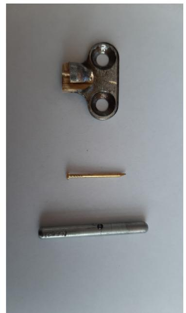
La 3ième opération est de limer la surface de la charnière pour permettre à la patte du verrou de se rabattre verticalement après insertion de l'axe.
